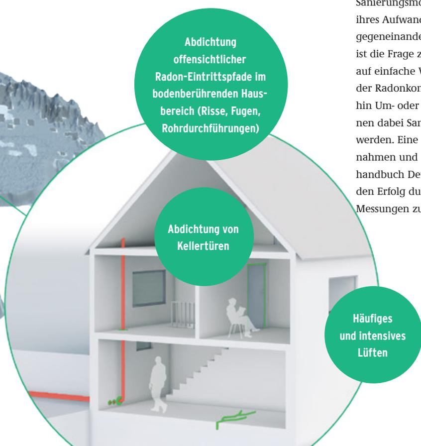
Abdichtung offensichtlicher Radon-Eintrittspfade im bodenberührenden Hausbereich (Risse, Fugen, Rohrdurchführungen)
